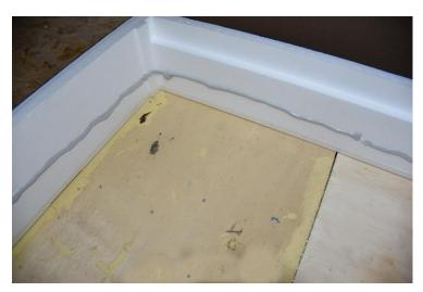
Die Dämmung wird bündig in die Halbzarge mit Silikon eingeklebt, wobei eine passende Unterlage ein Durchrutschen verhindert. Wer Ausdünstungen mit Folgen für die Bienen oder den Honig befürchtet, sollte einen im Aquarienbau oder im Lebensmittelbereich zugelassenen Klebstoff verwenden. Für einen Deckel habe ich für die rundum verlaufenden Dichtungsstreifen etwa 150ml Silikon gebraucht, also eine halbe Kartusche.
