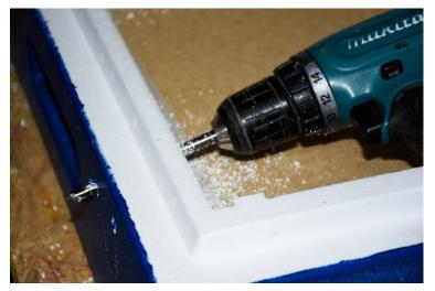
Damit die Feuchtigkeit, die nach oben austritt, abtransportiert wird, muss der Deckel belüftet werden. Dazu bohre ich an zwei gegenüber liegenden Seiten mit einem 8mm Holzbohrer oberhalb der eingeklebten Platte schräg von innen nach außen ein Loch. Dieses erweitere ich mit einem Forstnerbohrer schräg hoch von außen nach innen auf 20mm, damit die Luft gut durchströmen kann.
